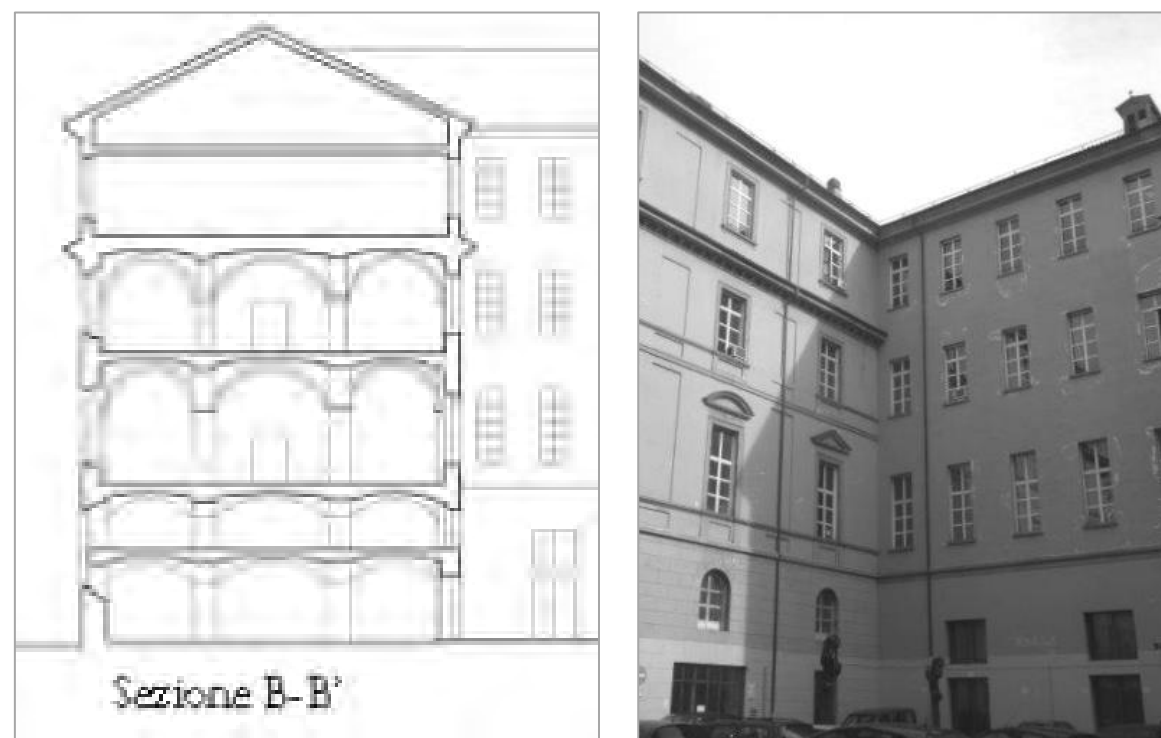
III.) a Sin., Sezione del “corpo a fulcri”, con indicazione del sistema delle volte ribassate dei mezzanini. A ds., incontro della manica a fulcri con il braccio nord della crociera castellamontiana.
